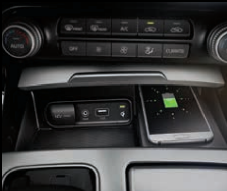
Carregador de celular por indução (celulares que possuem a tecnologia wireless charger).
